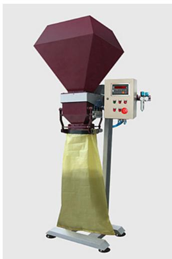
Весовой дозатор для сыпучих продуктов. Предназначен для автоматического взвешивания, дозирования и фасовки в любые мешки шириной не менее 410 мм сыпучих продуктов (сахар, крупы, гранулированные вещества и др.)
