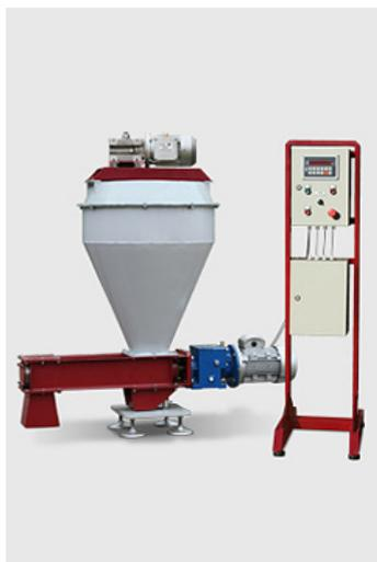
Дозатор шнековый используется для дозирования небольших порций сыпучих и плохосыпучих материалов в смеситель, другую емкость или на ленточный конвейер. Шнековый дозатор часто применяется в строительной или пищевой промышленности при выполнении небольших добавок в каждый замес.
