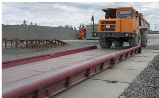
Инновационная разработка конструкторского бюро ГК «ФизТех». Мощные серийные автомобильные весы повышенной надежности. Предназначены для статического взвешивания большегрузных дорожных и внедорожных карьерных самосвалов (включая БелАЗы и их аналоги) и спецтранспорта с полным заездом на платформу.
