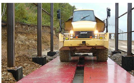
Важная составляющая качества весов – это используемые датчики колонного типа SigmaTech.
