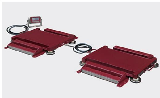
Малогабаритные электронные автомобильные весы для статического поосного или покосного взвешивания автотранспорта при поочередном или одновременном (в случае соединения платформ) наезде колес на платформы. Возможно совместное применение четырех, шести и более платформ для взвешивания автомобиля целиком в один заезд. Экономичный вариант автомобильных весов для весового контроля автотранспорта, организации мобильных весовых постов и контроля нагрузки на дорожное полотно на открытых площадках.
