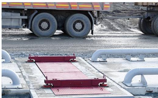
Весы ВА-В предназначены для поосного взвешивания любых автомобилей и автопоездов в движении и взвешивания осей в статике с последующим суммированием. Весы представляют собой грузоприемную платформу, установленную в металлическую раму на одном уровне с проезжей частью. Часто применяются в местах с большим потоком автомобилей или в условиях ограниченного пространства, например, на пунктах весового контроля или проходных.
