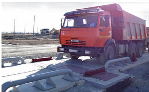
Важная составляющая качества весов – это используемые датчики. Датчики выполнены из нержавеющей стали 17-4PH, имеют наивысшую степень пылевлагозащиты IP68 – это 100% защита от пыли и работоспособность даже в затопленном состоянии.
