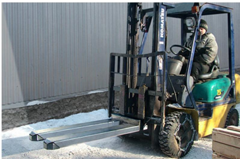
Весы изготавливаются в виде балочных накладок на вилы погрузчика.
