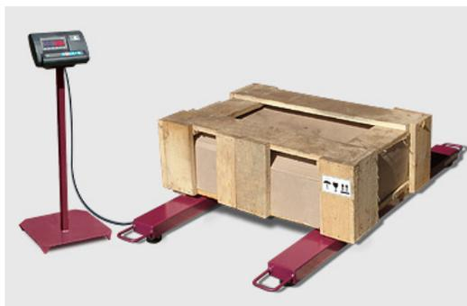
Применяются для взвешивания паллет (поддонов), больших ящиков, контейнеров, ёмкостей, длинномерных грузов, в том числе при фасовке металлопроката.
