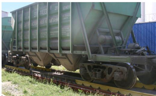
Весы вагонные предназначены для статического взвешивания железнодорожных вагонов и взвешивания в движении – поосно и потележечно в зависимости от модификации.
